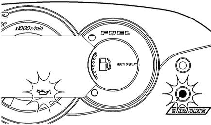
Nestas condições, reduzir a velocidade do motor, voltar a terra e verificar o nível do óleo do motor. (Ver os procedimentos para a verificação do nível de óleo do motor na página 48.) Se o nível do óleo estiver baixo, acrescentar óleo do motor suficiente para que este suba até ao nível adequado. Se o nível do óleo for suficiente, solicitar a um Concessionário Yamaha a verificação do veículo aquático.
