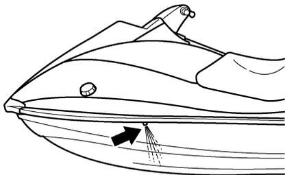
Para verificar o funcionamento do sistema de refrigeração, verificar se existe descarga de água pela saída piloto. Se não houver descarga de água pela saída, poderá não haver circulação da água de refrigeração no motor. Nestas condições, parar o motor e verificar a causa da anomalia. (Ver mais informações nas páginas 38 e 89.)
