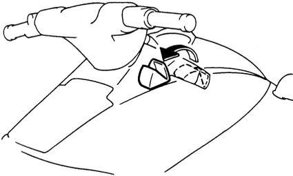
Com a alavanca do selector do sentido de marcha na posição de marcha à ré, o veículo pode colocado na água a partir de um reboque ou recuado em locais apertados em que a viragem do veículo não possa ser facilmente efectuada.
