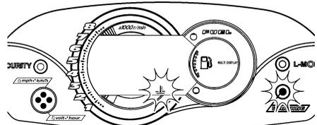
Se esta situação se verificar, reduzir imediatamente a velocidade do motor, colocar o veículo aquático em terra e, com o motor em funcionamento, verificar a descarga de água
