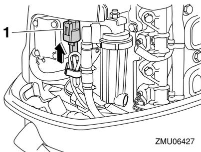
1. Acoplador do interruptor de detecção de água
