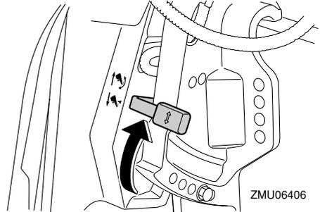
3. Incline ligeiramente o motor fora de bordo para cima para a posição pretendida e baixe a alavanca de bloqueio da inclinação para a posição fechada.
