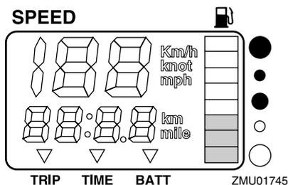
A leitura do nível de combustível pode ser pouco fiel devido à posição do sensor no depósito de combustível e ao comportamento do barco na água. A navegação em condições de inclinação ou de curva contínua pode originar leituras falsas.
