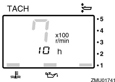
Para mudar o mostrador, pressione o botão “mode” (modo). O mostrador indica o total de horas, as horas do trajecto actual ou desligase.
