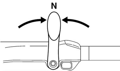
2. Levante a alavanca de bloqueio da inclinação para a posição aberta.
