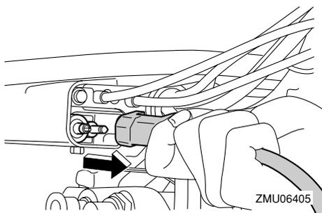
3. Aperte o parafuso do respiradouro no tampão do bocal do depósito de combustível (se equipado).
