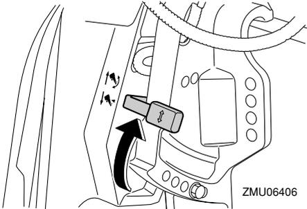
3. Segure na traseira do capot superior com uma mão, incline o motor para cima, e rode a alavanca de sustentação da inclinação na sua direcção ou empurre o botão de sustentação da inclinação em direcção à braçadeira de suporte, e, a seguir, coloque a alavanca de bloqueio da inclinação na posição fechada
