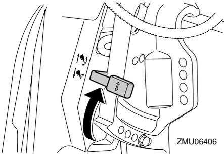
3. Segure a traseira do capot superior com uma mão e incline o motor para o ângulo pretendido.
