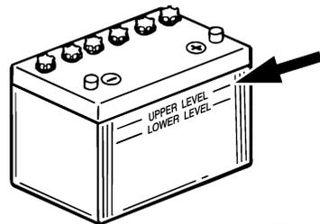
2. Verifique a carga da bateria. Se o barco estiver equipado com velocímetro digital, o voltímetro e o alarme indicador de
