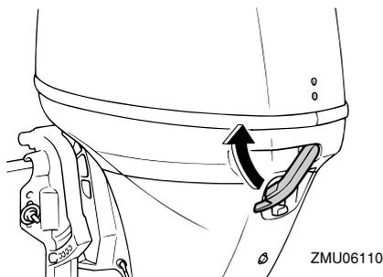
Depois de o instalar, verifique o encaixe do capot superior exercendo pressão com as duas mãos. Se o capot superior estiver solto, peça ao concessionário Yamaha que o repare.
