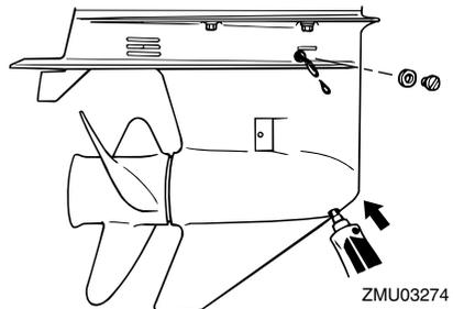
6. Coloque uma nova junta no obturador de nível do óleo. Quando o óleo começa a sair do orifício do obturador de nível do óleo, introduza e aperte o obturador de nível do óleo.
