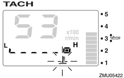
Pare imediatamente o motor se a buzina soar e o alarme indicador de falta de pressão de óleo ficar intermitente. Verifique a quantidade de óleo de motor e reabasteça de óleo, se necessário. Se o dispositivo de alarme acender, mantendo-se o nível de óleo de motor adequado, consulte o concessionário Yamaha.
