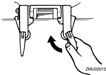
2. Se o motor dispuser de engate do cabo de inibição, convém usar um cabo ou corrente de inibição. Prenda uma das ex-
