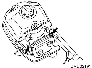
4. Entfernen Sie die Schrauben vom Startergehäuse, während Sie den Kraftstofftank anheben.
