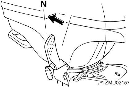
2. Falls der Motor mit einer Absperr-Reißleine ausgestattet ist, befestigen Sie dieses an einer sicheren Stelle an Ihrer Kleidung, Ihrem Arm oder Bein. Setzen Sie anschließend die Sperrgabel am anderen Ende der Reißleine in den Motor-Stoppsschalter ein.
