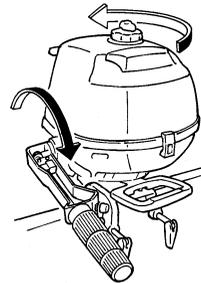
2. Drücken Sie den Schalthebel fest in Richtung des Hecks.
