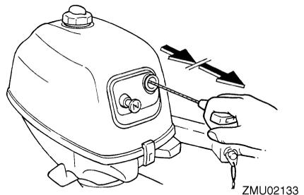
6. Schieben Sie nach dem Start des Motors den Handstartergriff wieder langsam in seine Grundposition zurück, bevor Sie ihn loslassen.
