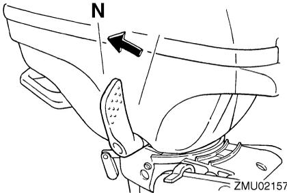
2. Ziehen Sie den Einsteller des Lenkwiderstands durch Drehen im Uhrzeigersinn fest, um ein Freidrehen des Motors zu verhindern.
