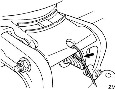
3. Befestigen Sie die Klemmhalterung am Spiegel, indem Sie die Schrauben verwenden, die im Lieferumfang des Außenbordmotors (falls dieser verpackt war) enthalten sind. Hinsichtlich der Einzelheiten setzen Sie sich bitte mit Ihrem Yamaha-Händler in Verbindung.
