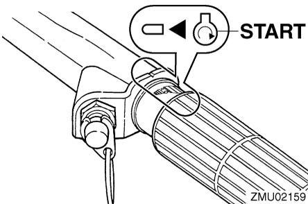
4. Stellen Sie den Chokeknopf in die Position "START" (Start). Schieben Sie den Knopf nach dem Start des Motors in die Position "RUN" (Betrieb).
