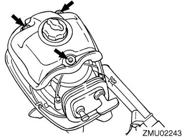
3. Entfernen Sie die Schrauben vom Startergehäuse.
