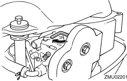
12. Während Sie den Kraftstofftank anheben, führen Sie das verknotete Ende der Not-Reißleine in die Aussparung im Schwungrad ein und wickeln Sie die Leine im Uhrzeigersinn eine bis zwei Umdrehungen um das Schwungrad.
