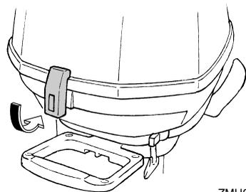
Nach dem Einbau die Motorhaube auf festen Sitz überprüfen, indem Sie mit beiden Händen dagegen drücken. Sollte die Motorhaube locker sein, lassen Sie sie von Ihrem Yamaha-Händler reparieren.
