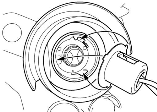
6. Reposer le cache du porte-ampoule à l'arrière du phare.
