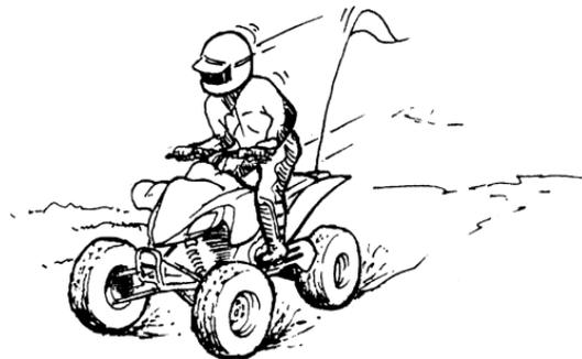
Si les roues arrière commencent à déraper, il est possible de regagner le contrôle du véhicule (si l'espace disponible est suffisant) en manœuvrant dans la direction du dérapage. Il est déconseillé de freiner ou d'accélérer avant d'avoir repris le contrôle du véhicule.
