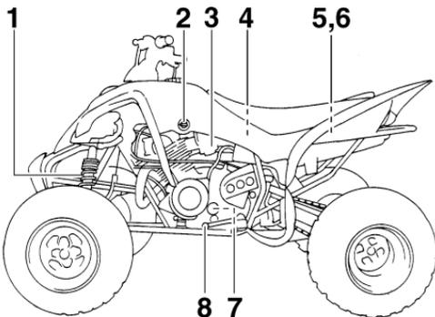
1. Bague de réglage de la précontrainte de ressort de combiné ressort-amortisseur avant
