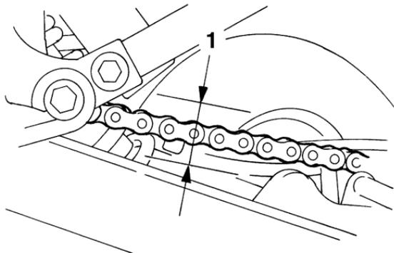
1. Tension de la chaîne de transmission
