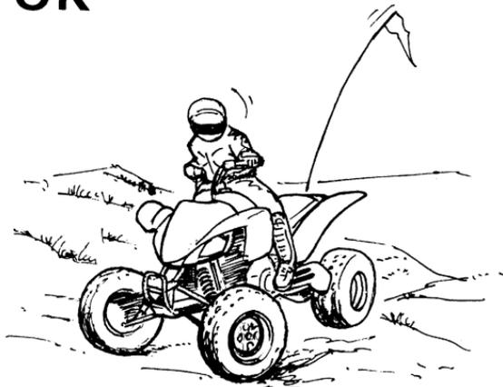
Si le VTT a calé ou s'il s'est arrêté et que l'on juge pouvoir atteindre le sommet de la côte, redémarrer prudemment afin que les roues avant ne se soulèvent pas, car cela pourrait entraîner la perte de contrôle du véhicule. S'il est impossible de continuer l'ascension, descendre du VTT. Tourner le VTT en le poussant, puis redescendre la colline. Si le VTT se met à reculer, surtout NE PAS actionner le frein arrière pour tenter de freiner le mouvement et ne pas essayer d'engager une vitesse. Le
