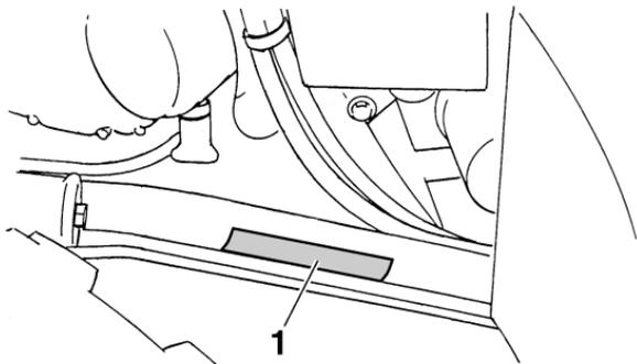
1. Numéro d'identification du véhicule (côté avant gauche)
