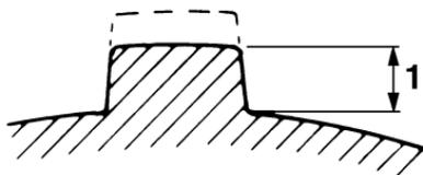
1. Limite d'usure de pneu
