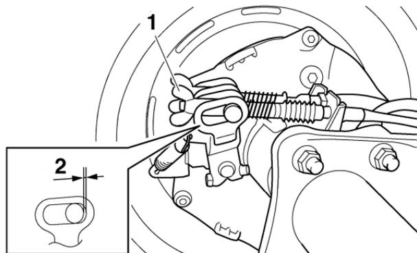
1. Écrou de réglage de la garde du levier de frein
