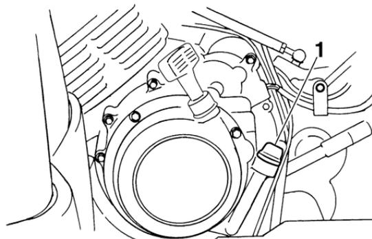
1. Bouchon de remplissage de l'huile moteur
