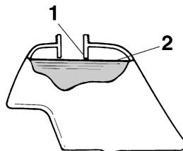
1. Tube de remplissage du réservoir de carburant
