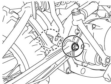
Contrôler les pivots du bras oscillant aux fréquences spécifiées dans le tableau des entretiens et graissages périodiques.
