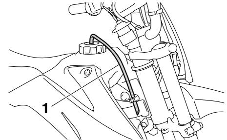
1. Durite de mise à l'air de réservoir de carburant
