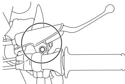
Contrôler le fonctionnement du levier de frein avant chaque départ et lubrifier les articulations du levier quand nécessaire.
