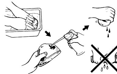
6. Enduire toute la surface de l'élément en mousse d'huile du type recommandé, puis éliminer l'excès d'huile en comprimant l'élément.
