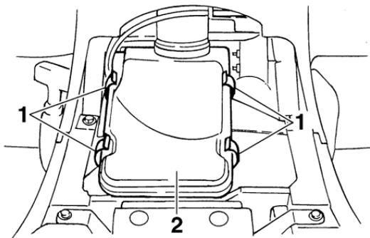
1. Soporte de la cubierta de la caja del filtro de aire
