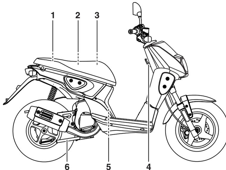
1. Bouchon du réservoir d'huile moteur 2 temps (page 3-5/3-7)
