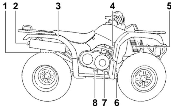
1. Anillo de ajuste de la carga previa del resorte del conjunto del amortiguador trasero
