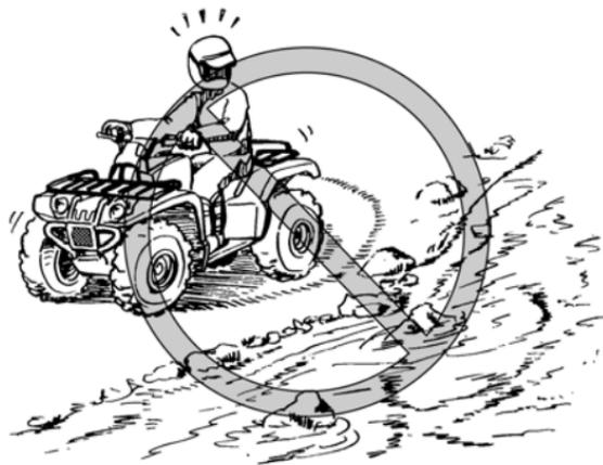
Compruebe los frenos cuando salga del agua. Si es necesario, frene varias veces para que el rozamiento seque los forros. No siga conduciendo el ATV sin comprobar que éste ha recuperado su capacidad de frenado. **¡ADVERTENCIA! Si los frenos están mojados, la capacidad de detener el vehículo puede verse reducida, con el consiguiente riesgo de perder el control.** [SWB02621]
