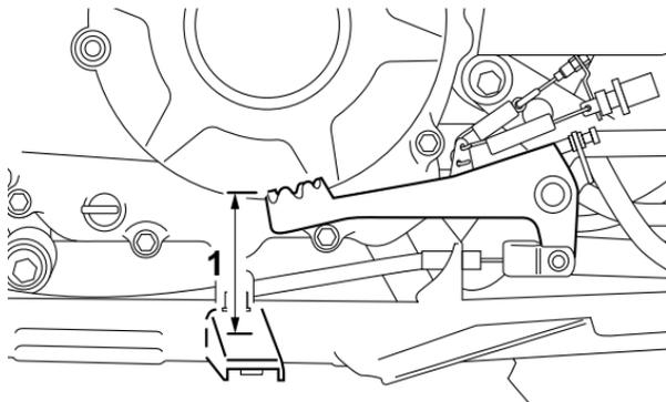
1. Distancia entre el pedal de freno y el soporte del reposapiés
