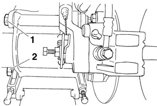
1. Perno de sujeción del eje (superior)
