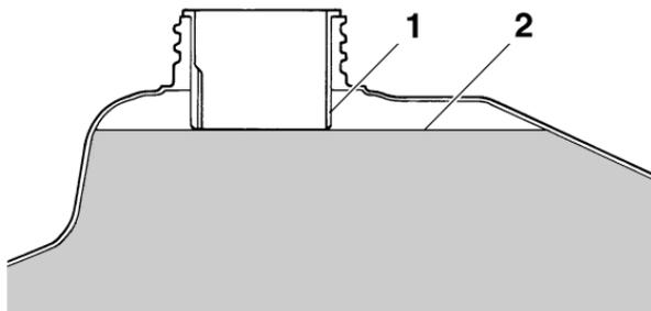
1. Tubo de llenado del depósito de gasolina
