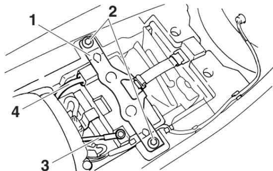
1. Placa de sujeción de la batería
