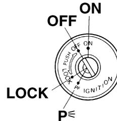
O interruptor principal/bloqueio da direcção controla os sistemas de ignição e iluminação, e é utilizado para bloquear a direcção.
