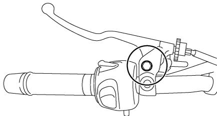
Antes de cada viagem deverá verificar o funcionamento das alavancas do travão e da embraiagem e, se necessário, deverá lubrificar os pivôs da alavanca.
