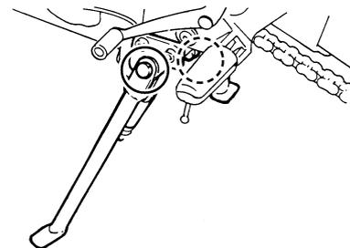
Antes de cada viagem, deverá verificar o funcionamento do descanso lateral e, se necessário, deverá lubrificar o pivô do descanso lateral e as superfícies de contacto de metal com metal.
