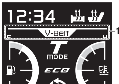
1. Indicador de substituição da correia em V “V-Belt”
