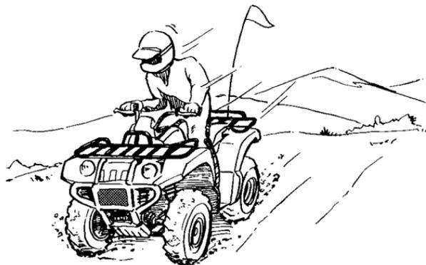
Si les roues arrière commencent à dérapager, il est possible de regagner le contrôle du véhicule (si l'espace disponible est suffisant) en manœuvrant dans la direction du dérapage. Il est déconseillé de freiner ou d'accélérer avant d'avoir repris le contrôle du véhicule.
