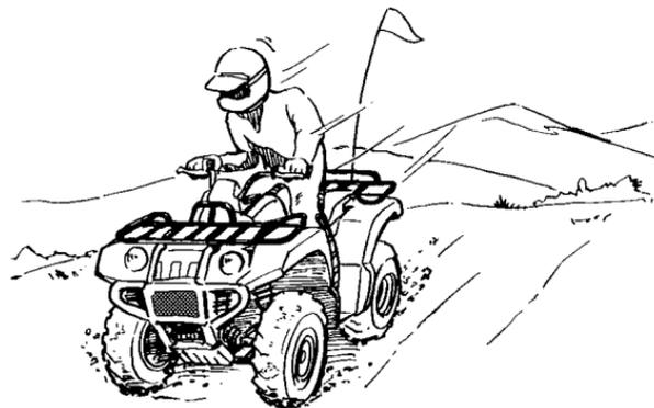
Si las ruedas traseras del ATV comienzan a patinar en sentido lateral, generalmente se puede recuperar el control girando la dirección (si hay suficiente espacio para ello) en el sentido del derrape. No se recomienda acelerar ni frenar hasta haber corregido el derrape.
