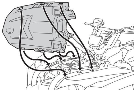
2. Coloque las fijaciones rápidas.
