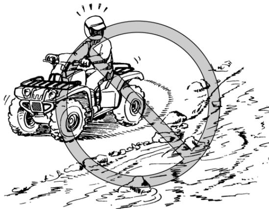
Compruebe los frenos cuando salga del agua. Si es necesario, acci3nelos varias veces para que la fricci3n seque el forro. No siga conduciendo el ATV sin comprobar que 3ste ha recuperado su capacidad de frenado. **¡ADVERTENCIA! Si los frenos est3n mojados, la capacidad de detener el veh3culo puede verse reducida, con el consiguiente riesgo de perder el control.** [SWB02622]
