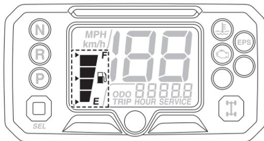
El medidor de gasolina indica la cantidad de gasolina que contiene el depósito. A medida que disminuye el nivel de gasolina, los segmentos del medidor de gasolina desaparecen desde la “F” (lleno) hasta la “E” (vacío). Cuando comience a parpadear el último segmento, ponga gasolina lo antes posible.
