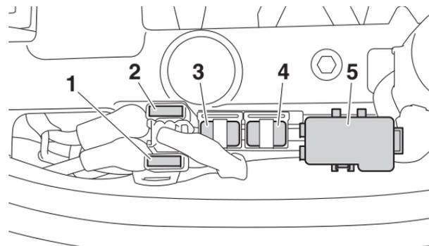
1. Fusible de repuesto del sistema de inyección
