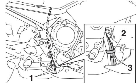
1. Tubo de respiração e tubo de descarga do depósito de combustível
