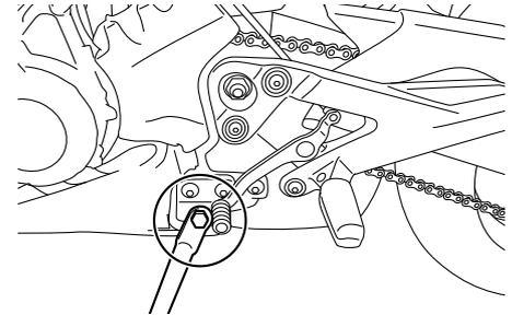
Antes de cada viagem, deverá verificar o funcionamento do descanso lateral e, se necessário, deverá lubrificar o pivô do descanso lateral e as superfícies de contacto de metal com metal.
