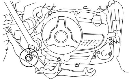
Contrôler le fonctionnement de la pédale de frein avant chaque départ et lubrifier l'articulation de la pédale quand nécessaire.
