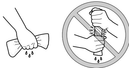
6. Enduire toute la surface de l'élément en mousse d'huile du type recommandé, puis éliminer l'excès d'huile en comprimant l'élément.
