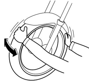
Os rolamentos de roda dianteiros e traseiros têm de ser verificados nos intervalos de tempo especificados na tabela de lubrificação e manutenção periódica. Se houver uma folga no cubo da roda ou se a roda não virar suavemente, solicite a um concessionário Yamaha que verifique os rolamentos de roda.
