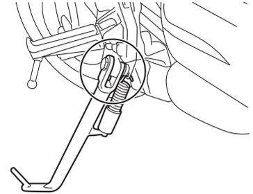
Antes de cada viagem, deverá verificar o funcionamento do descanso lateral e, se necessário, deverá lubrificar o pivô do descanso lateral e as superfícies de contacto de metal com metal.
