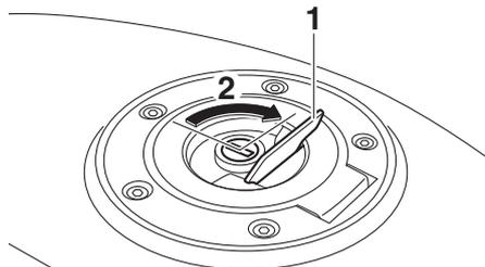
1. Cobertura da fechadura da tampa do depósito de combustível
