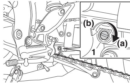
1. Parafuso ajustador da força amortecedora de recuo
