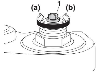
1. Parafuso ajustador da força amortecedora de recuo
