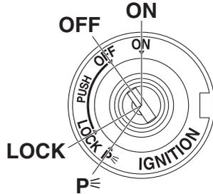
O interruptor principal/bloqueio da direcção controla os sistemas de ignição e iluminação, e é utilizado para bloquear a direcção. As várias posições são descritas a seguir.
