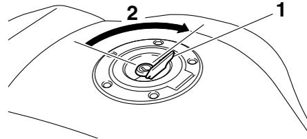
1. Cobertura da fechadura da tampa do depósito de combustível
