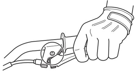
Lubrifier l’articulation des leviers de frein avant et arrière aux fréquences spécifiées dans le tableau des entretiens et graissages périodiques.
