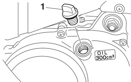
1. Bouchon de remplissage de l'huile de boîte de vitesses
