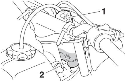
1. Bouchon du réservoir d'huile moteur 2 temps
