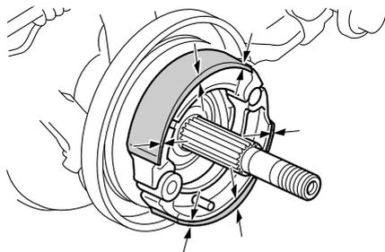
Si l'épaisseur d'une garniture d'une mâchoire de frein est inférieure à 1.5 mm (0.06 in), faire remplacer les mâchoires par un concessionnaire Yamaha.
