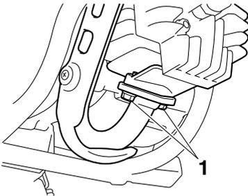
1. Vis de tubulure d'échappement
