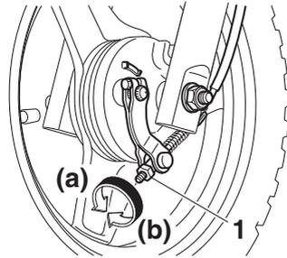
1. Écrou de réglage de la garde du levier de frein avant
