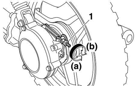
1. Écrou de réglage de la garde du levier de frein arrière
