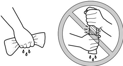
6. Die gesamte Oberfläche des Filterschaumstoffs mit dem vorgeschriebenen Öl benetzen und dann überschüssiges Öl ausdrücken.
