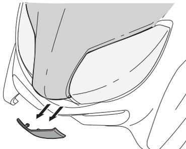
2. Retire os parafusos e, de seguida, puxe a carenagem para fora conforme ilustrado.
