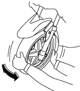
Os rolamentos de roda dianteiros e traseiros têm de ser verificados nos intervalos de tempo especificados na tabela de lubrificação e manutenção periódica. Se houver uma folga no cubo da roda ou se a roda não virar suavemente, solicite a um concessionário Yamaha que verifique os rolamentos de roda.
