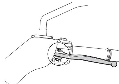
Os pontos de articulação das alavancas dos travões dianteiro e traseiro devem ser lubrificados nos intervalos especificados
