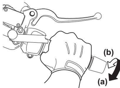
A velocidade pode ser ajustada acelerando e desacelerando. Para aumentar a velocidade, rode o punho do acelerador na direcção (a). Para reduzir a velocidade, rode o punho do acelerador na direcção (b).
