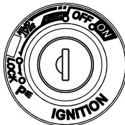
O interruptor principal/bloqueio da direcção controla os sistemas de ignição e iluminação, e é utilizado para bloquear a direcção. As várias posições são descritas a seguir.
