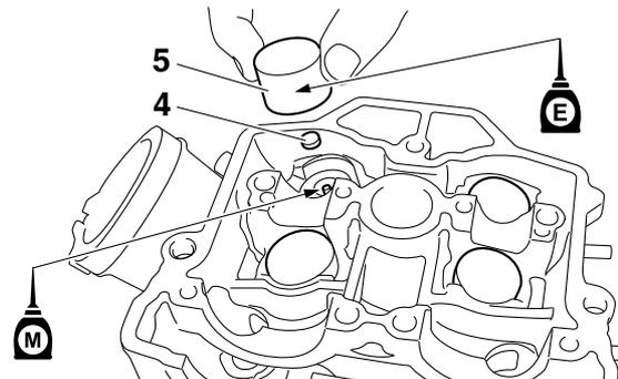
f. Monter les arbres à cames (d'admission et d'échappement).
