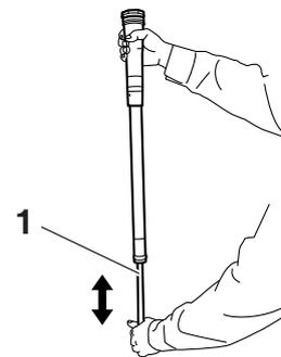
11. Protéger l'amortisseur équipé "1" à l'aide d'un chiffon et le comprimer complètement pour permettre à l'excédent d'huile de s'écouler du côté de la soupape de base.
