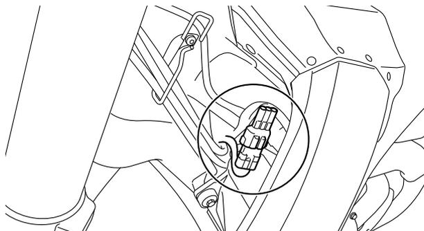
2. Brancher l'outil de diagnostic du système d'injection de carburant.
