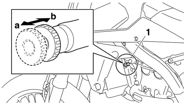
Le démarrage d'un moteur froid nécessite une plus grande quantité d'air admis, celui-ci étant fourni par le bouton du démarreur/la vis de ralenti "1".
