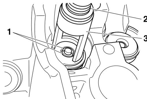
5. Attacher les clavettes de soupape sur la queue de soupape en frappant légèrement sur son embout à l'aide d'une massette.
