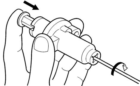
b. La tige du tendeur étant complètement enroulée et le repère UP "a" du tendeur étant orienté vers le haut, monter le joint "1", le tendeur de chaîne de distribution "2" et le joint "3", puis serrer le boulon "4".
