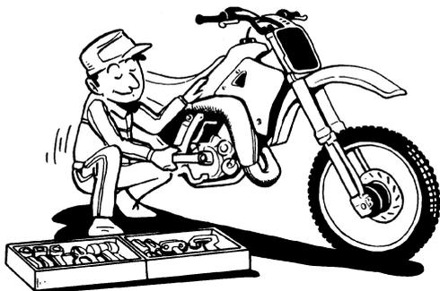
3. Lors du démontage, vérifier et mesurer les pièces requises et conserver un enregistrement de celles-ci pour pouvoir vous y reporter lors du montage. Par ailleurs, organiser les engrenages, les cylindres, les pistons et autres pièces pour chaque section pour ne pas les confondre ni les perdre.
