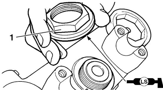
9. Après avoir serré l'écrou, vérifier si le mouvement de la direction est régulier. Sinon, régler la direction en desserrant petit à petit l'écrou.
