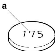
d. Sélectionner une plaquette de réglage avec un jeu de soupape approprié dans le tableau de sélection des plaquettes de réglage.
