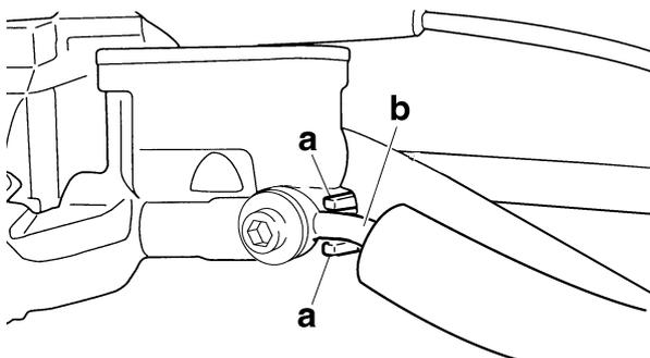
3. Verser du liquide de frein dans le réservoir du maître-cylindre de frein jusqu'au niveau spécifié.
