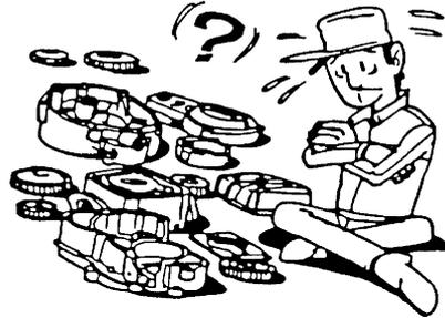
4. Lors du démontage, nettoyer chacune des pièces et les ranger dans des plateaux pour chaque section.
