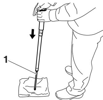
12. Laisser l'huile s'écouler par l'orifice "a" de l'amortisseur équipé.
