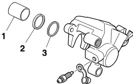
a. Insuffler de l'air comprimé dans l'ouverture de raccord de durite de frein pour faire sortir le piston de l'étrier de frein.
