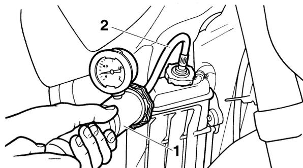
3. Activer le testeur pour appliquer la pression de test.
