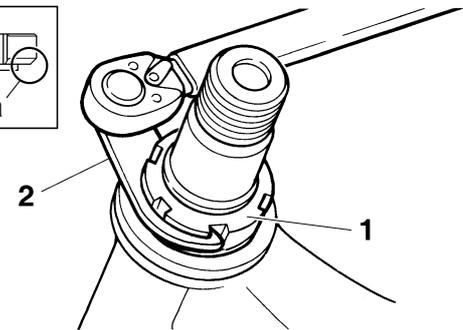
5. Contrôler la colonne de direction en la tournant d'une butée à l'autre. S'il y a la moindre gêne, démonter la colonne de direction et contrôler le roulement de direction.
