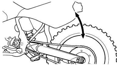
**FEDERVORSPANNUNG DER HINTERRAD-STOSSDÄMPFER EINSTELLEN**
