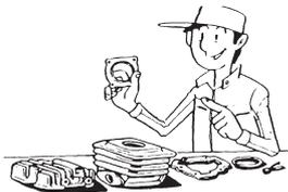
4. Alle ausgebauten Teile reinigen und in der Reihenfolge des Ausbaus auf einer sauberen Unterlage ablegen. Dies gewährleistet einen zügigen und korrekten Zusammenbau.
