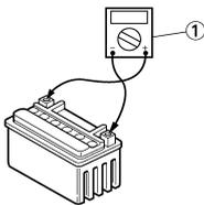
Messgerät-Pluskabel → Batterie-Pluspol
